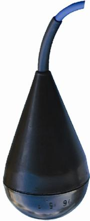
Der Niveauregler MS1 EX kann mit einem zertifizierten, eigensicheren Stromkreis zur Überwachung und / oder Regulierung eines Flüssigkeitsniveaus in den Ex – Bereichen der Zone 0, 1 und 2 sowie den Gasgruppen IIA, IIB und IIC, die durch brennbare Stoffe im Bereich der Temperaturklassen T1 bis T6 explosionsgefährdet sind, eingesetzt werden.
