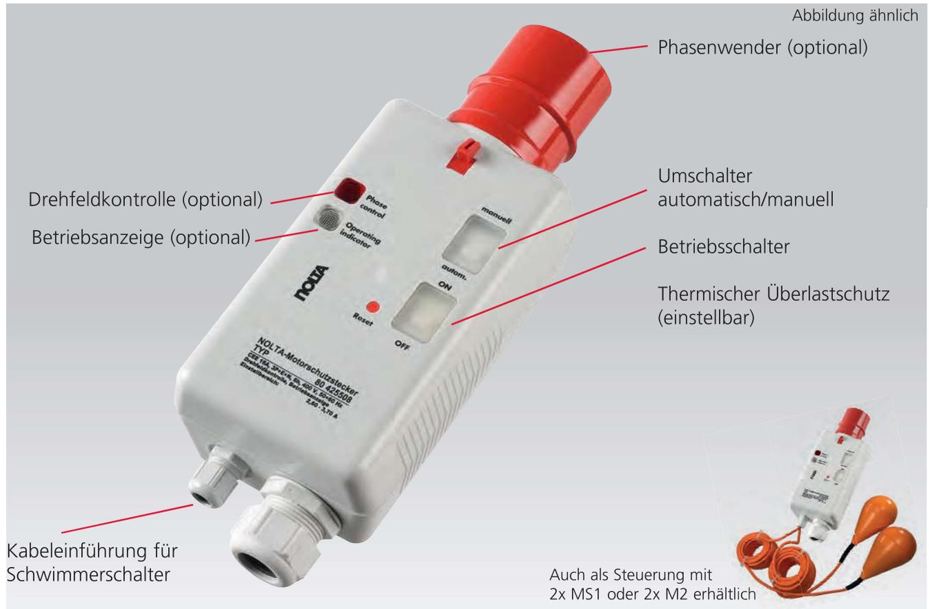
Die NOLTA Schützkombination bietet optimalen Schutz für alle Elektromotoren bis 5,5 kW, z.B. bei:
